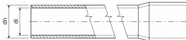
Produktbeschreibung: Kunststoffstangenrohr, flammwidrig, mit angeformter Muffe
