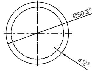
**Produktbeschreibung:** LWL-Schutzrohr innen längs gerieft, Schutzrohr zum Einblasen oder Einziehen von LWL-Kabel
