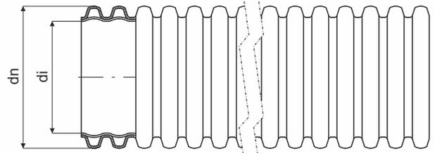
**Produktbeschreibung:** halogenfreies, UV-beständiges, flexibles Kabelschutzrohr zum mechanischen Schutz von Strom- und Telekommunikationsleitungen aller Art
