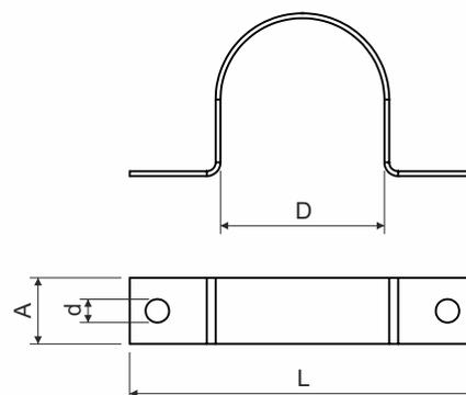
**Beschreibung:** Die Schellen sind zur Befestigung flexibler Stahlrohre auf dem Untergrundmaterial geeignet.
