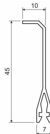
**Produktbeschreibung:** wird verwendet, um das Innere der Kanäle zu unterteilen um somit eine bessere Handhabung der eingeführten Kabel sowie bessere Übersicht zu ermöglichen
